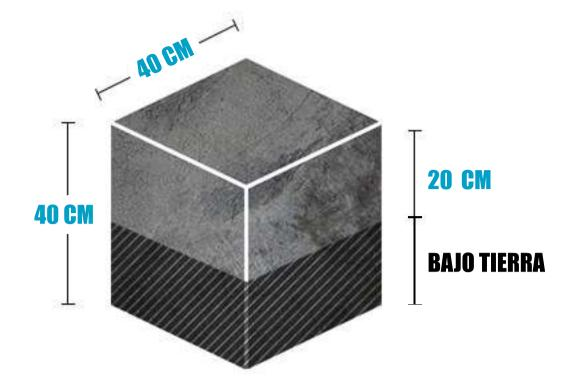
La altura de los pilares puede variar según las condiciones del terreno o por gusto personal. Podrían llegar requerir barras de metal para mejorar su capacidad de carga.
